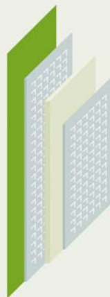
Gesamtdicke der Klebstoffschichten ohne Adeckungen ca. 220 µm
